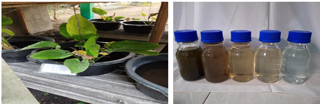
Gambar 4. Constructed Wetland (CW) dengan Tanaman Melati Air dan contoh limbah dari awal hingga akhir pengamatan .
