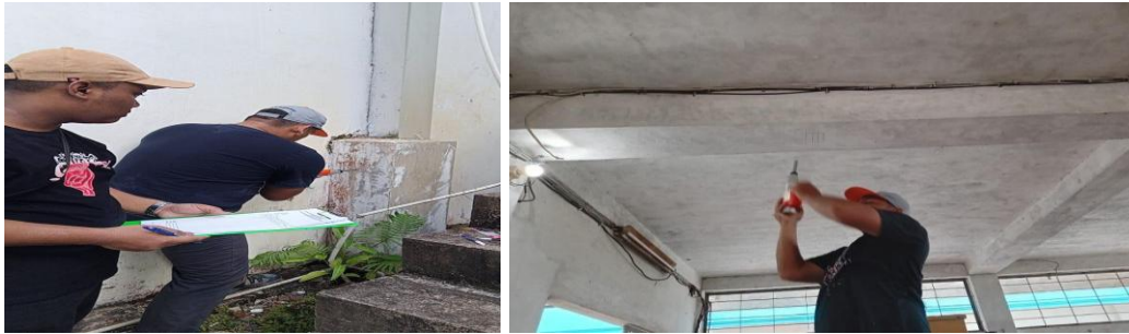
Gambar 6. Pengujian mutu struktur beton dengan hammer test
