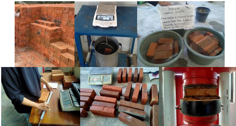
Gambar 3. Proses Pengujian Batu Bata di Laboratorium Teknik Sipil Unsulbar
