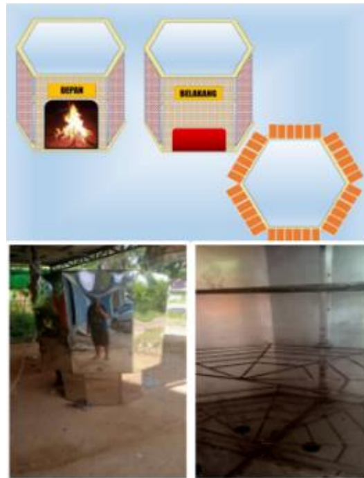
Gambar 3. Desain Steam Untuk Sterilisasi Jamur
